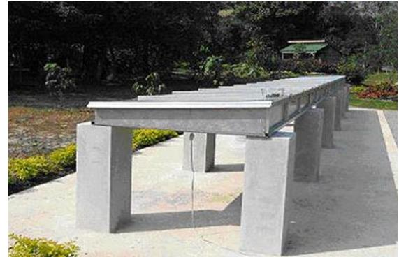
เครื่องอบแห้งด้วยแสงอาทิตย์แบบ Cabinet Type Dryer
