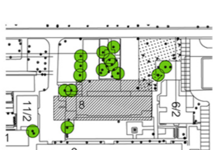
PLAN 1:1000 ● ต้นไม้เดิมที่เก็บรักษาไว้ ● ต้นไม้เดิมที่ไม่สามารถเก็บรักษาไว้
