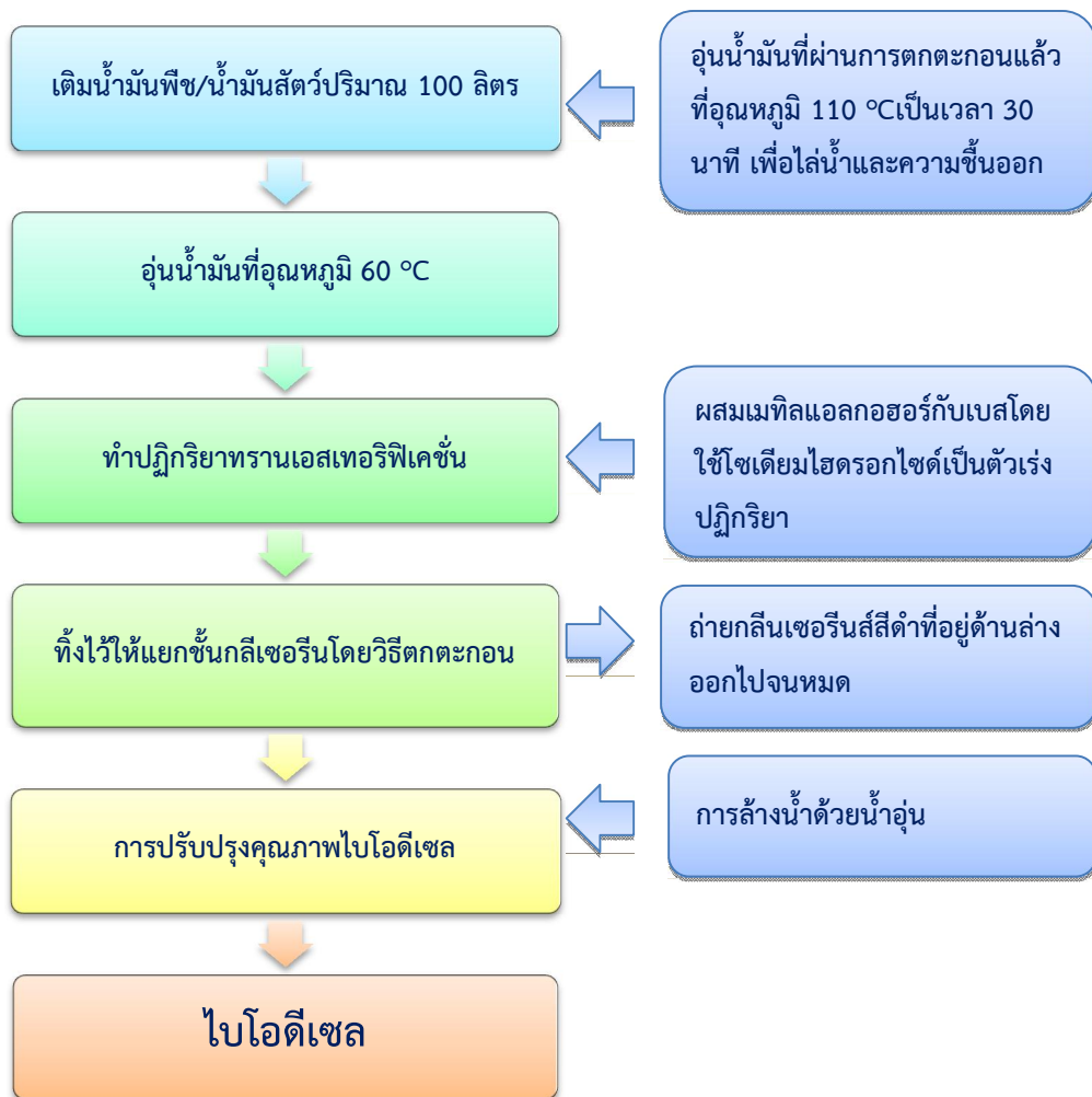
รูปแสดงแผนผังกระบวนการผลิตของเครื่องไปโอดีเซลชุมชน
