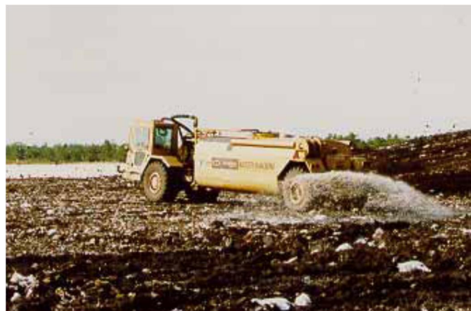
รูปแบบการหมุนเวียนน้ำชะขยะกลับสู่ชั้นฝึงบกลบขยะมูลฝอย
