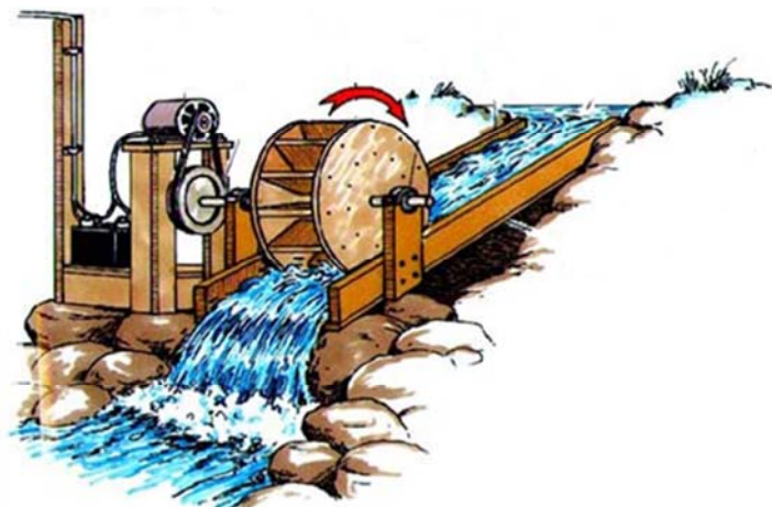
รูปแสดงแบบใช้กับหัวน้ำต่ำกำลังผลิตน้อยใช้แบบ Poncelet Wheel
